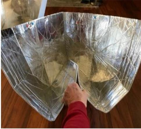
1. Empuje el centro inferior del reflector ←hacia arriba y doble la solapa hacia adentro. A medida que el centro se pliega, presione los lados hasta que el reflector quede plano. →
